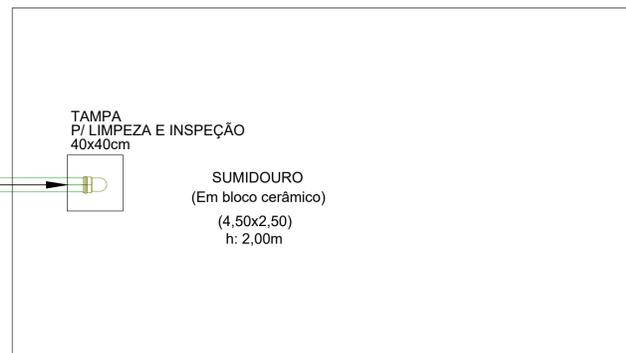
PLANTA BAIXA - SISTEMA DE TRATAMENTO DE ESGOTO S/ESC.
