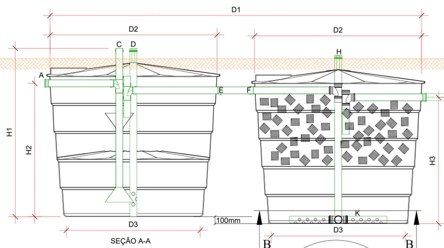
CORTE - SISTEMA DE ESGOTO S/ESC.
