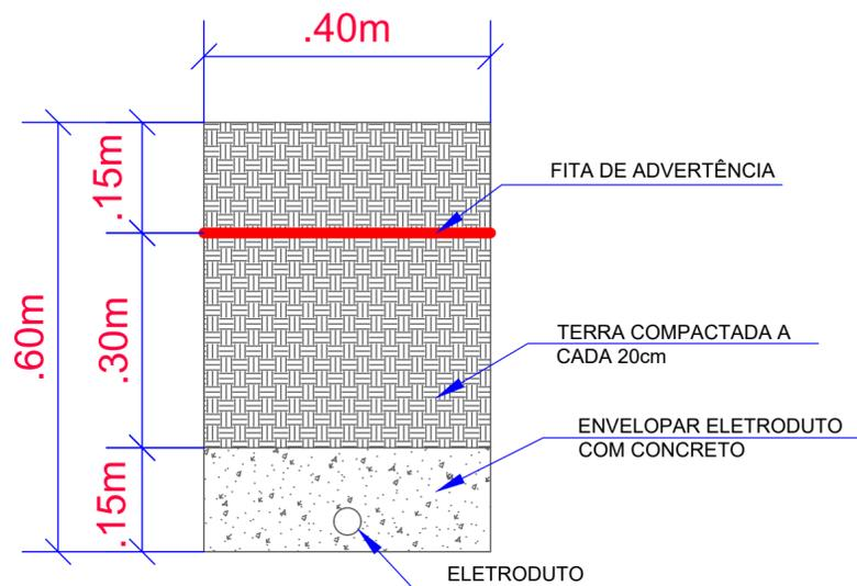
*Detalhes Construtivos Valas Sem Escala*
