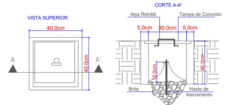
*Detalhes Construtivos da Caixa de Inspeção do Aterramento Sem Escala*
