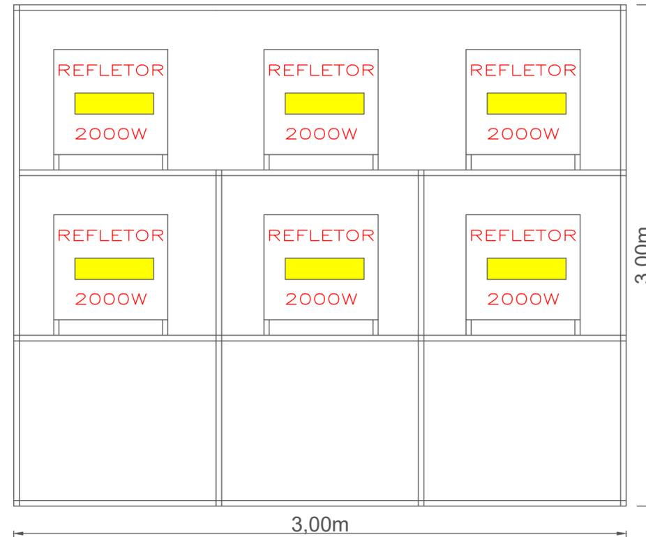
*Detalhes Construtivos Refletores Sem Escala*
